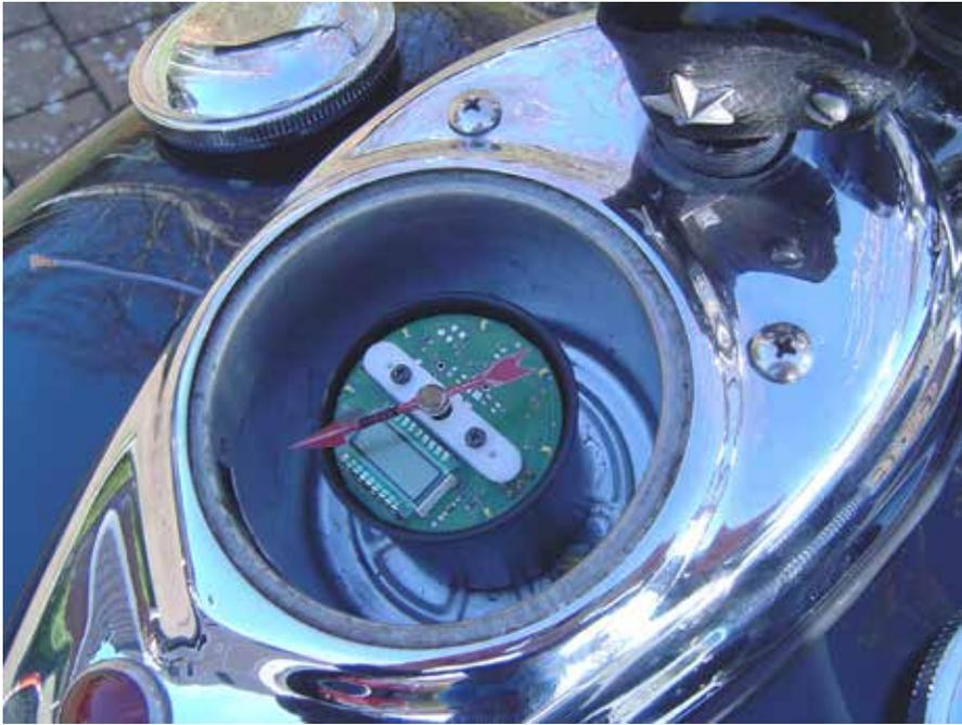
Die Anpassung des Übersetzungsverhältnisses des Honda Tachos erschien mir zu kompliziert. Also galt es, den elektronischen Tachometer in das Gehäuse des defekten Tachos einzubauen (Bild 2).
