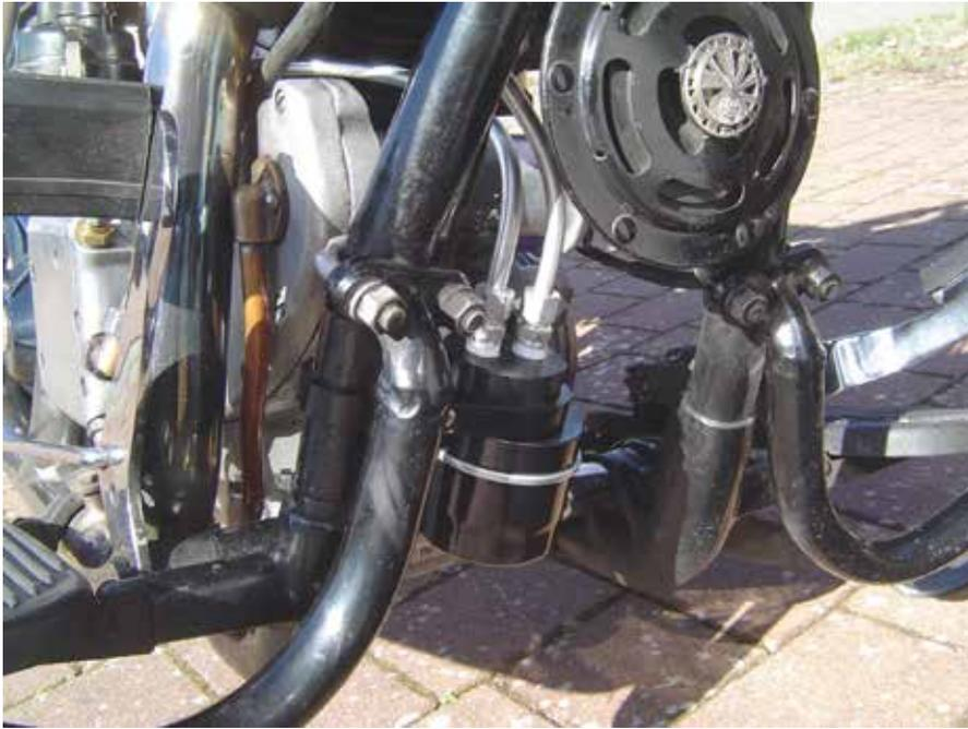
Aluminium handelt. Da mochte ich den Schraubenschlüssel nicht so sehr fest ansetzen. Ein befreundeter Hydraulik Schlosser schnitt die Gewinde etwas nach und schon passte alles perfekt und selbstdichtend ineinander. Etwas Teflonband dazwischen und zusammenschrauben (Bild 5).
