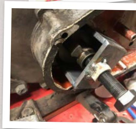
In Reparaturanleitungen heißt es an dieser Stelle immer: „Der Zusammenbau erfolgt in umgekehrter Reihenfolge“. Dabei muss das Primärritzeln, die Primärkette, der Kupplungskorb und der Lichtmaschinenantrieb mit der dazu gehörenden Anlaufscheibe gleichzeitig eingesetzt werden. Keine Angst, das ist leichter, als es sich anhört. Die Muttern werden mit mittelfester Schraubensicherung eingesetzt. Vorher empfiehlt es sich, Die Muttern und die Gewinde mit Bremsenreiniger zu entfetten.
