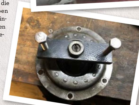
Als nächstes müssen die Muttern vom Primärritzel und der inneren Kupplungsnahe gelöst werden. Dabei darauf achten, dass die Mutter auf der Kupplungsnahe ein Linksgewinde hat, also im Uhrzeigersinn gedreht werden muss, um sie zu lösen. Ich benutze zum Gegenhalten ein Werkzeug, das ich vor Jahren mal von Bernd Wysinsky ge-
